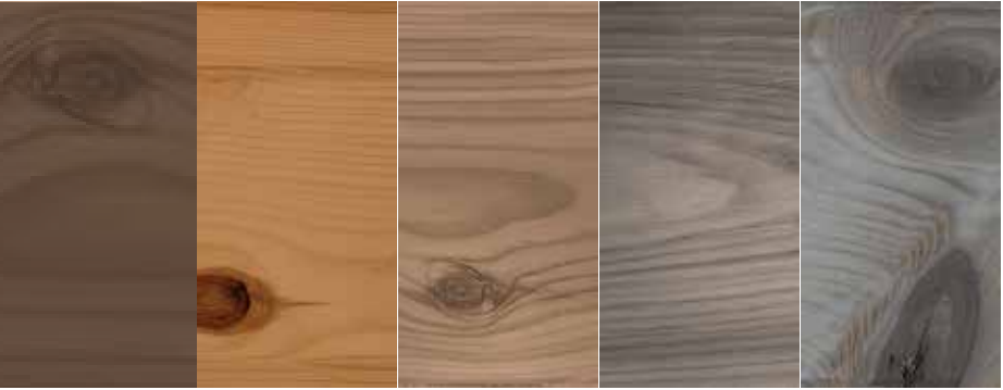
Marrón tostado Resultado natural del proceso de modificación. Gris metalizado Con el tiempo los productos no tratados envejecen a este tono.
